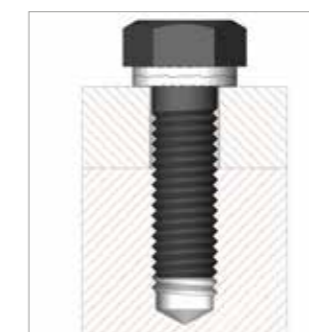
Sechskantschraube im Sackloch gesichert
