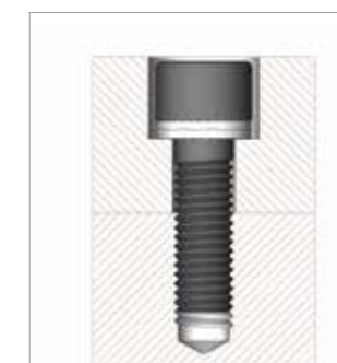
Zylinderschraube in Senkung gesichert
