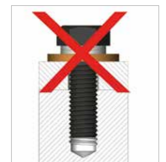
Keine Sicherungsfunktion in Kombination mit frei rotierenden Unterlegscheiben
