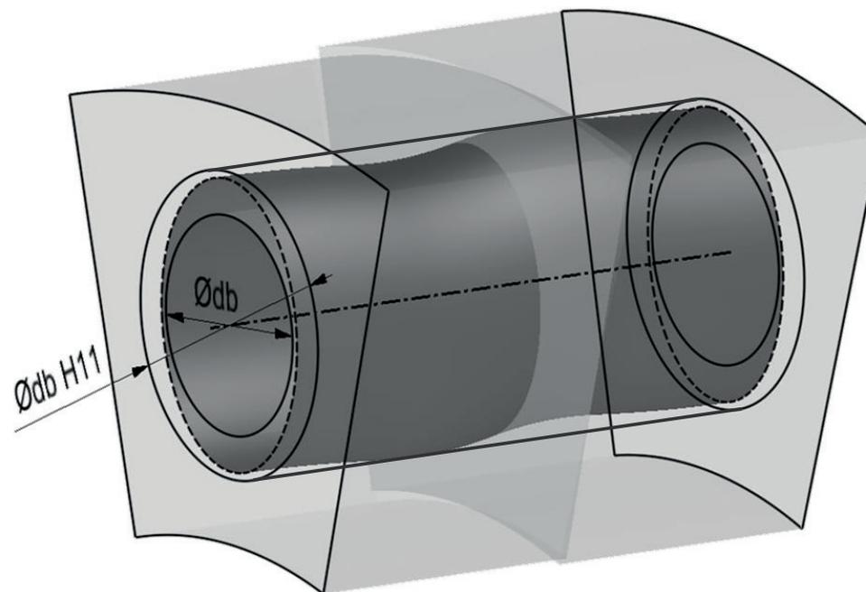
Die Summe aller Toleranzen muss kleiner sein als H11; d.h. die Bohrungen müssen zwischen zwei konzentrischen Zylindern liegen mit Durchmessern  $\varnothing_{db}$  und  $\varnothing_{db} H11$ .
