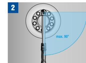
Aflojar cada perno de compresión girándolos un máximo de ¼ de vuelta. Dar la vuelta completa hasta cumplir con el desajuste de todos los pernos de compresión
