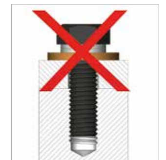
平ワッシャー等、回転してしまう他の座金とは併用できません
