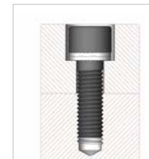
座ぐり穴に固定された六角穴付ボルト
