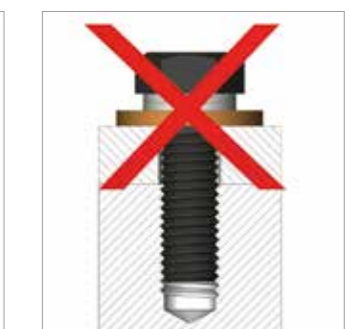
Ingen låsfunktion i kombination med osäkrad bricka.
