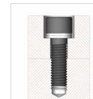
Insexskruv säkrad i försänkt hål
