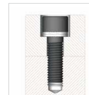
沉孔中的内六角螺栓定位防松
